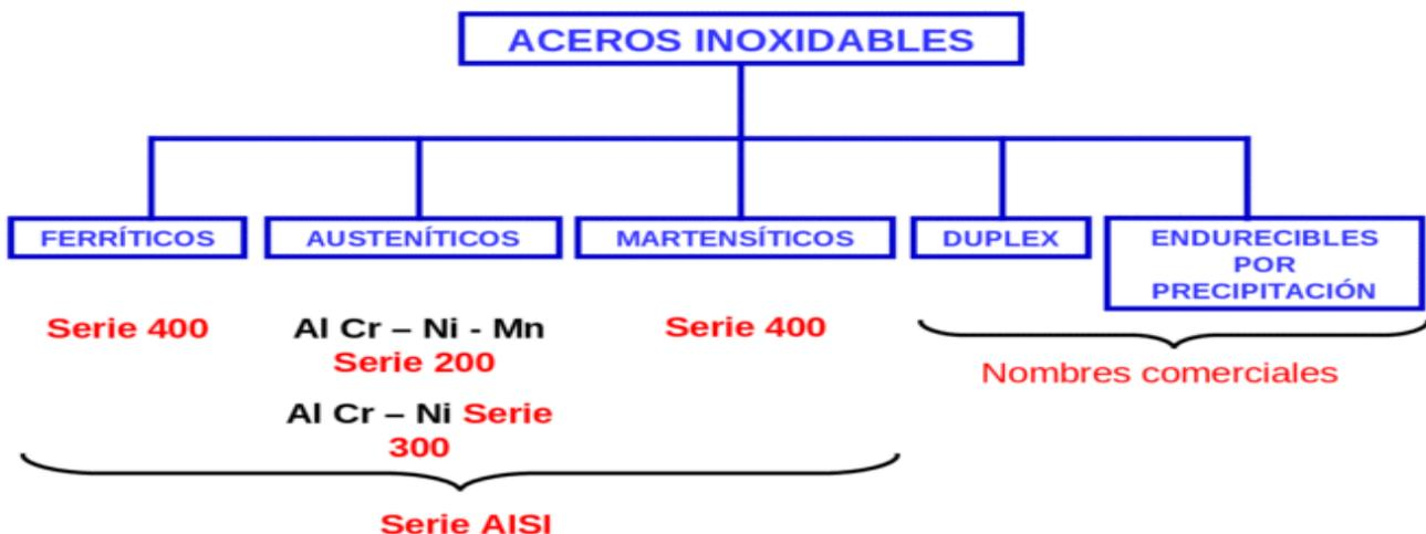
Esta clasificación viene dada por la estructura metalográfica del acero, la cual se establece en dependencia de la composición química que presente. En una figura siguiente puede observarse el *Diagrama de Shaeffler*, el cual describe la relación entre estructura y composición química para estos aceros, basados en los conceptos de *níquel equivalente* y *cromo equivalente*.
