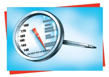
■ Lectura Instantánea - dial — no están diseñados para permanecer en el alimento durante la cocción. Inserte la sonda en toda la longitud del dispositivo sensor, normalmente de 2 a 2 ½ pulgadas. Cuando mida la temperatura de un alimento de poco espesor, como una hamburguesa o pechuga de pollo sin hueso, inserte la sonda de lado de manera que el dispositivo sensor quede en el centro. Son necesarios de 15 a 20 segundos para que aparezca la temperatura exacta.
