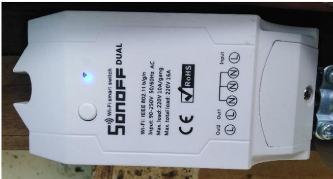
Figura 25. Módulo interruptor SONOFF no estándar para controlar doble carga
