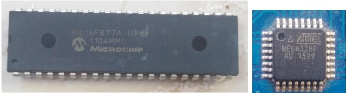
Figura 14. Microcontroladores PIC16F877A y MEGA328P de Microchip y Atmel
